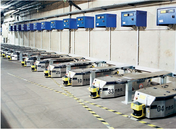
Abb. 15: Automatisches Batterieladen in der Anlage im Uniklinikum Köln
