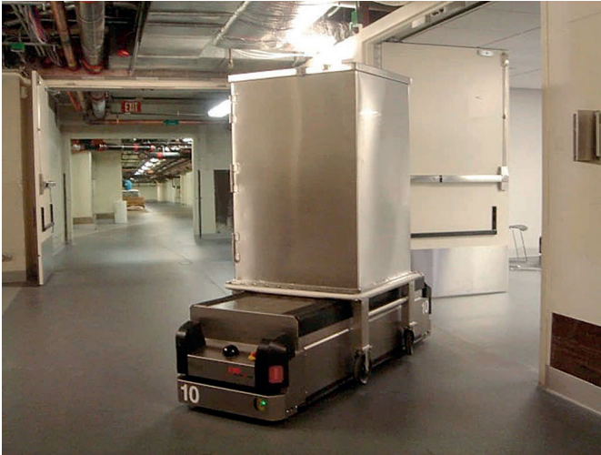
Abb. 33: FTF bei der Durchfahrt durch eine Brandabschnittstür
