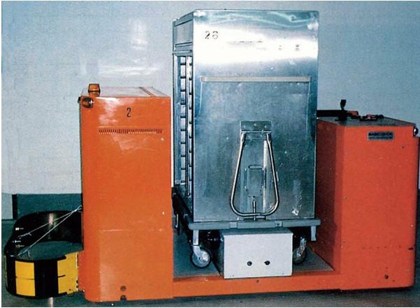
Abb. 9: Der eingesetzte Fahrzeugtyp im Kantonsspital Basel: seitliche Aufnahme über Rollenbahn [5]
