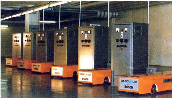
Abb. 7: Für die insgesamt sieben Fahrzeuge gab es einzelne Batterieladestationen [5]
