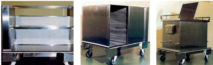
Abb. 8: Rollcontainer der ersten AWT-Anlage in FTS-Technik: Universal-, Speisen- und Müllcontainer [5]
