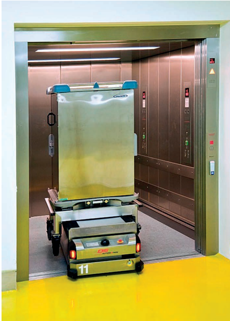
Abb. 32: FTF bei der Einfahrt in einen Aufzug
