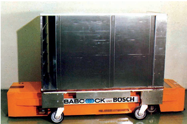
Abb. 5: Fahrzeugtyp ATR-UFS 01 als Unterfahrschlepper [4]
