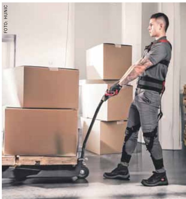
Die passiven Exoskelette von Hersteller Hunic unterstützen die Mitarbeiter beim Handling von Kisten und Kartons.
