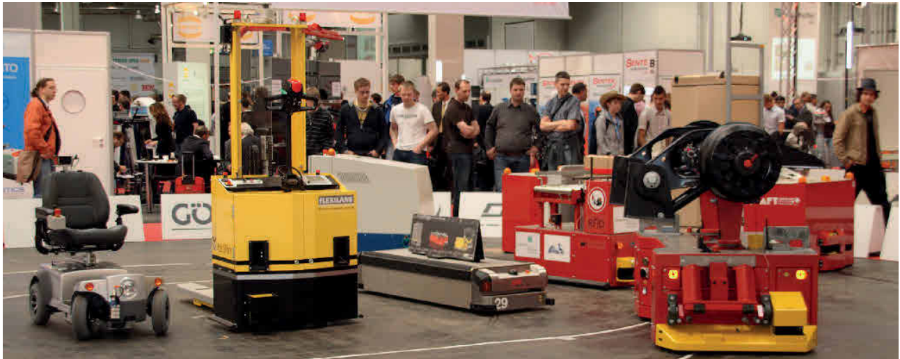
Bild 4 FTF von sieben unterschiedlichen Herstellern unter der FTS-Leitsteuerung openTCS im FTS-Ballett auf der Hannover Messe (Forum-FTS 2009). Foto: Verfasser
