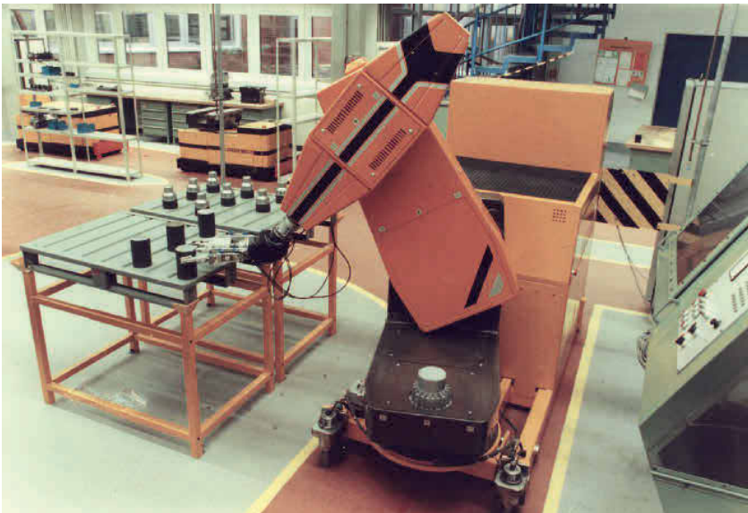
Bild 2 Der weltweit erste mobile Industrieroboter MOBIROB an der Universität Duisburg im Jahr 1985. Foto: Verfasser
