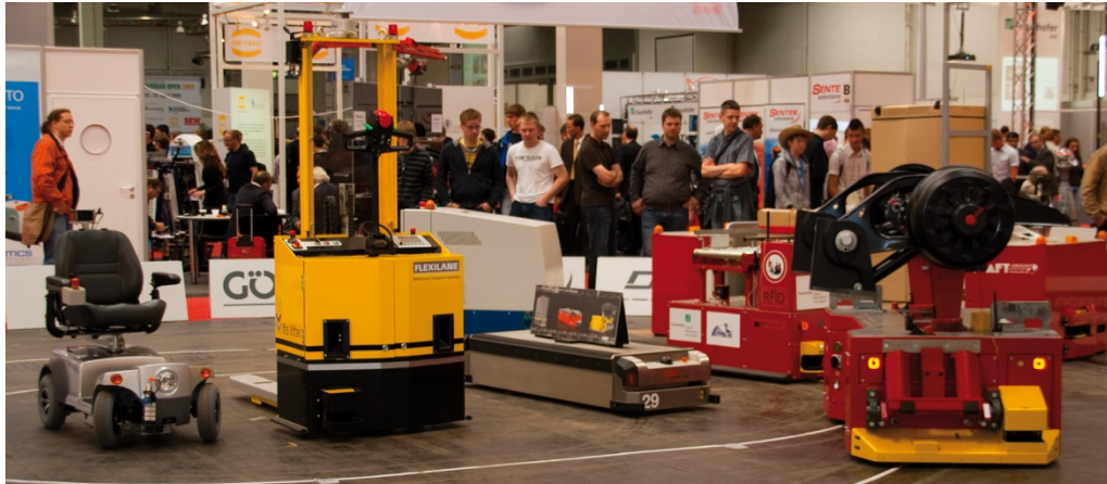
Bild 2 FTF von sieben unterschiedlichen Herstellern unter der FTS-Leitsteuerung openTCS im FTS-Ballett auf der Hannover Messe (Forum-FTS 2009)
