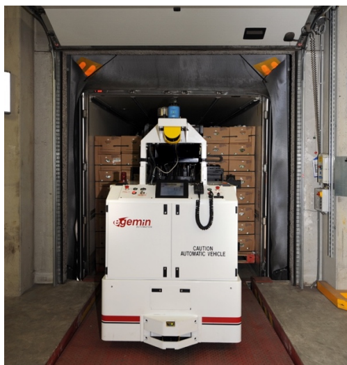
Bild 5 Automatische LKW- Be- und Entladung (Egemin ATL 2007)
