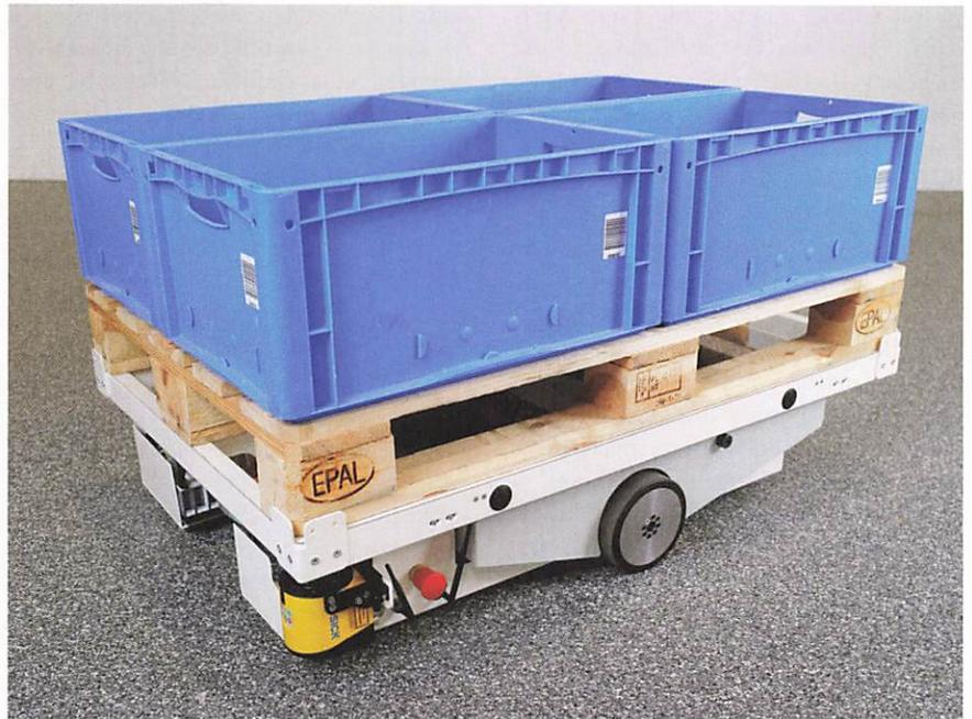
Bild 2 Das Stuart-Fahrwerk kann Bodenunebenheiten sicher ausgleichen. Foto: Fraunhofer IML
