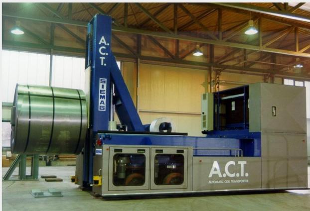
Stahlcoils mit einem Gewicht von 30 t, Dornaufnahme (Quelle: Siemag)
