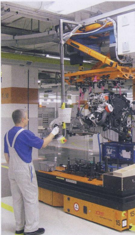
3 Manuelle Abnahme des fertigen Triebsatzes mit einem Kran
