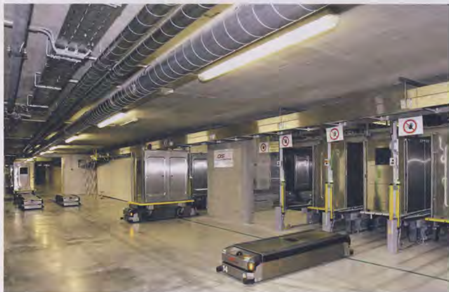
Die Kliniklogistik mit FTS – wie hier im Landeskrankenhaus Klagenfurt – ist für Krankenhäuser ab ca. 600 Betten eine Bereicherung.
