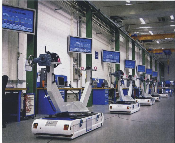
tionsbatterien erfolgt mit einem im Fahrzeug eingebauten Ladegerät. Dazu werden bei Bedarf die Fahrzeuge am Wochenende per Stromkabel an die Steckdose angeschlossen.
