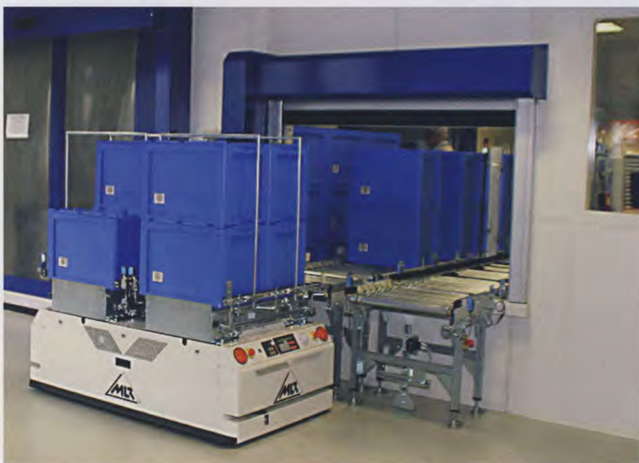
2 Ein klassisches FTS der dritten Epoche: Bewährte Technologien ergeben zuverlässige und betriebssichere Lösungen (Bild: MLR System)
