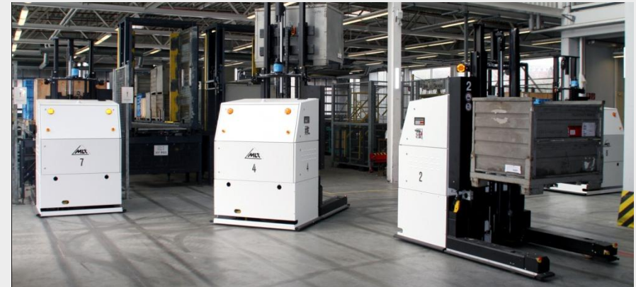
Taxibetrieb: automatische Gabelhubwagen verknüpfen flexibel Fertigungsbereiche bei Deutz (Quelle: MLR)
