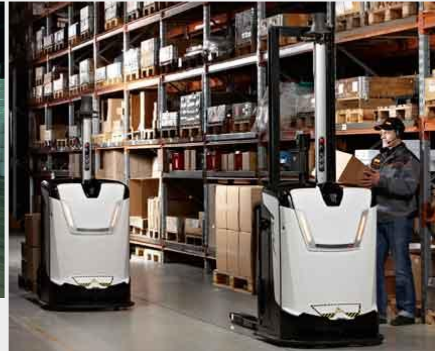
Gabelhubwagen beim Einsatz in der Kommissionierung (Quelle: Rocla, 2010)
