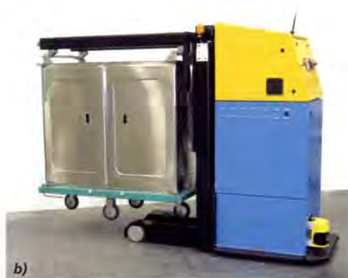
4 Im heutigen Klinikeinsatz: Unterfahr-FTF (a) und Gabelhub-FTF (b) zum Transport von Rollcontainern
