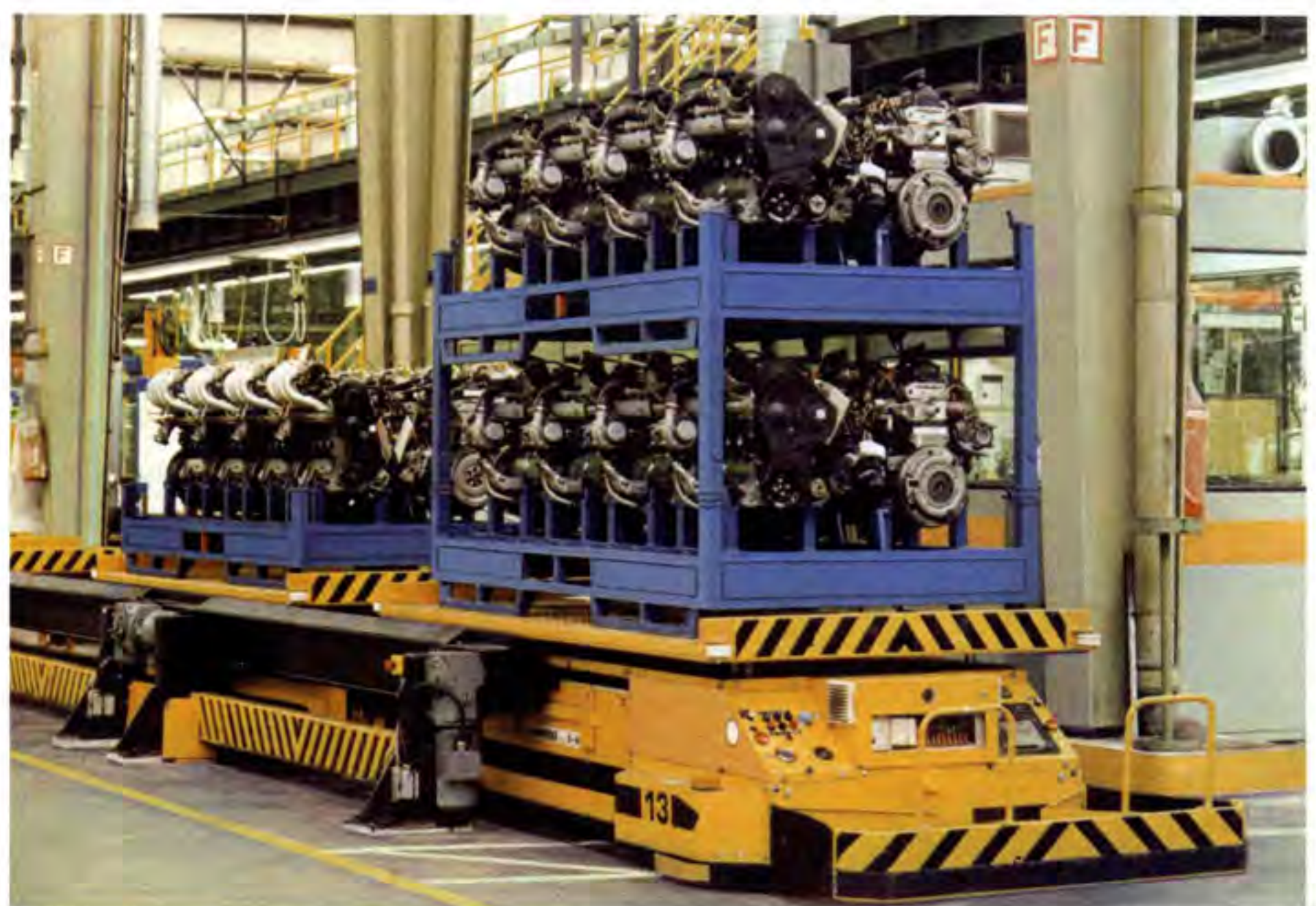
3 Typisches Beispiel für die zweite FTS-Epoche in der Automobilindustrie: 45 FTF bei VW auf 20 km Leitdraht
