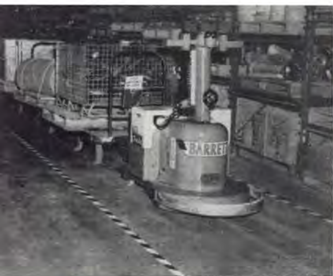
2 Oldie aus dem Jahr 1958: Eines der ersten FTS, als Zugmaschine für fünf Anhänger genutzt (Bild: Barrett-Cravens)
