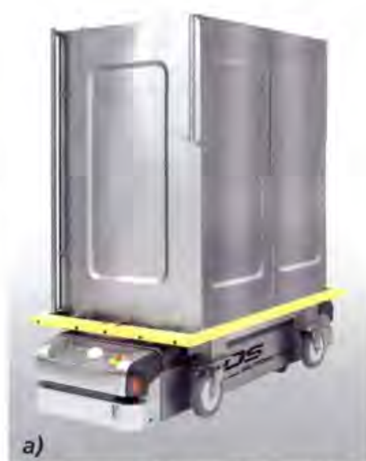
4 Im heutigen Klinikeinsatz: Unterfahr-FTF (a) und Gabelhub-FTF (b) zum Transport von Rollcontainern
