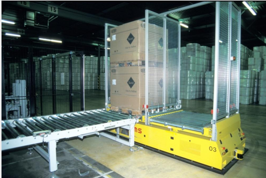
Ein Huckepack-FTF für zwei Europaletten zur automatischen Übergabe auf einen Rollenförderer. Einsatz bei DuPont (Quelle: DS Automotion)
