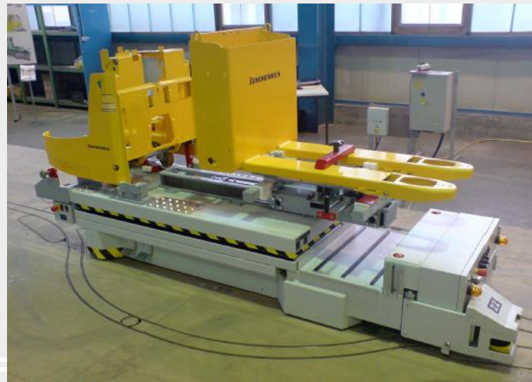
Taxibetrieb: automatische Gabelhubwagen verknüpfen flexibel Fertigungsbereiche bei Deutz (Quelle: MLR)
