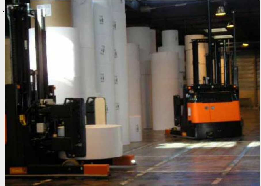
Einsatz im Papierrollenlager: Blocklager, 6 Rollen hoch (Quelle: Rocla)
