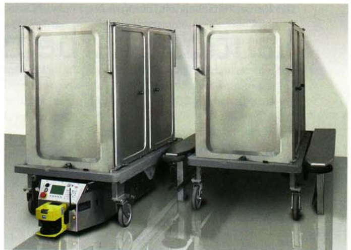
Einfache Abstellplätze für AWT-Container, die unter ergonomischen Gesichtspunkten neu entwickelt wurden.
