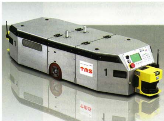
Das Fahrerlose Transportfahrzeug (FTF) mit Andockvorrichtung für AWT-Container, Sicherheits-Laserscanner, Antennen für Funk-Datenübertragung und Bedienfeld.
