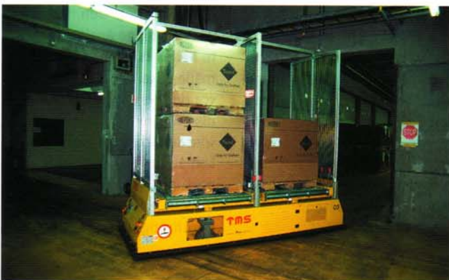
Ein FTF bei der Durchfahrt durch ein Brandschutztor
