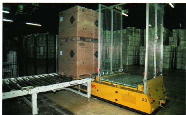
Deutlich zu sehen ist der Käfigaufbau zur Ladungssicherung
