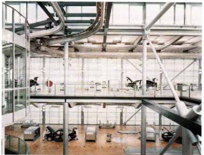
1 Endmontage des „Phaeton“ auf zwei Ebenen in der „Gläsernen Manufaktur“
