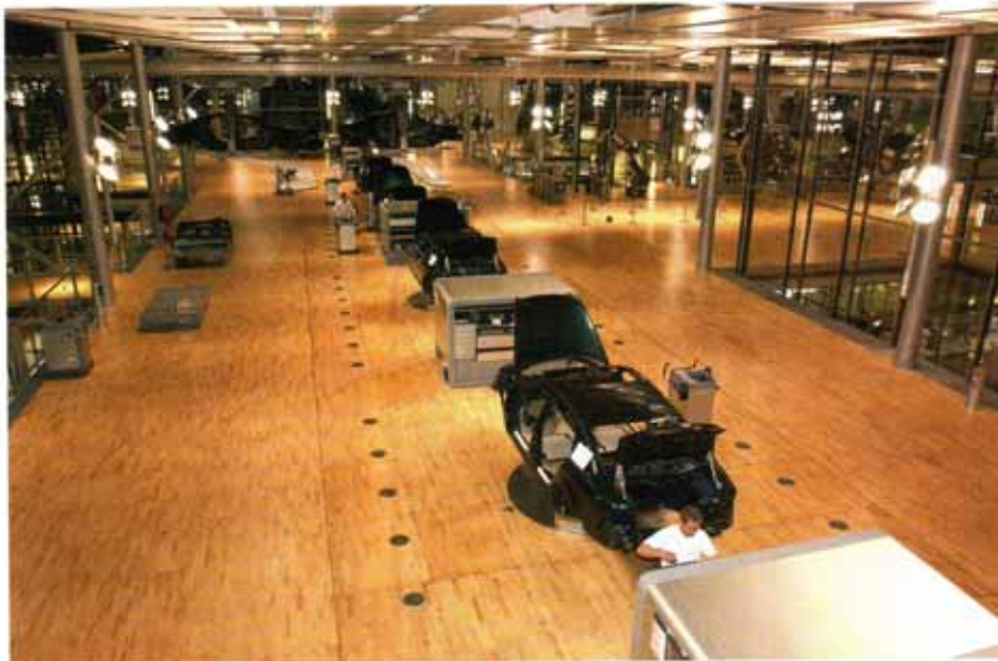
③ Schuppenband und per Rasternavigation geführte FTF
