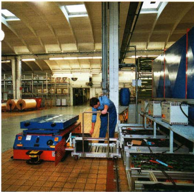
Der manuelle Batteriewechsel findet am Ende einer jeden Schicht statt
