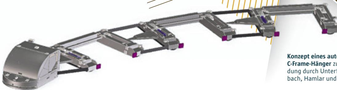
**Konzept eines automatischen Routenzuges mit C-Frame-Hänger** zur automatischen Be- und Entladung durch Unterfahr-FTF (Konzept von Grenzbach, Hamlar und Forum-FTS).
