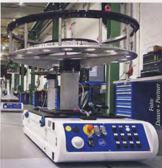
Hier hat der Hersteller das Thema sicherer Betrieb konstruktiv gut durchdacht: Bedienelemente und Not-Halt-Taster sind gut zugänglich
