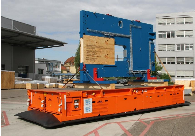
Bild 11: Innovationsbeispiel 4 – Schwerlast-FTF des Herstellers MLR System, Ludwigsburg
