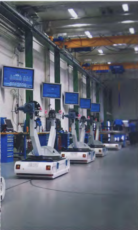
Das FTS vom Typ Variocart mit drehbarem Montageaufbau (Quelle: Daum + Partner Maschinenbau GmbH)
